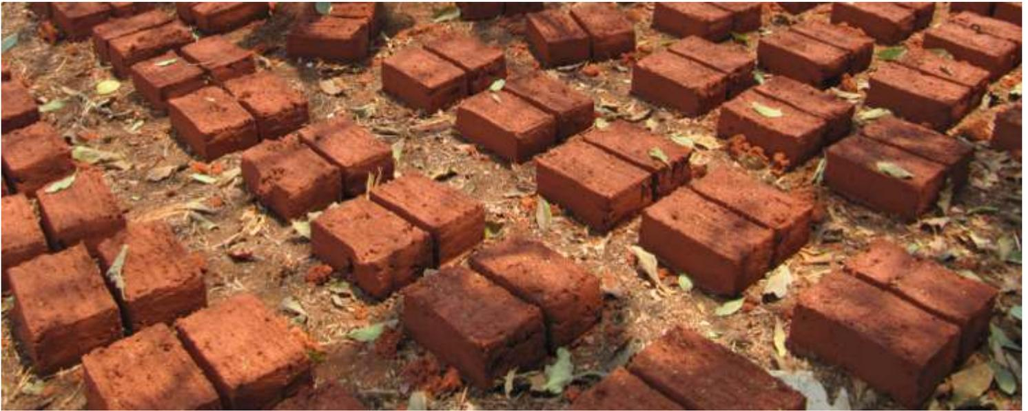
Tijolos adobe são feitos com terra, esterco fresco, palha picada, água e formas. As formas podem ser feitas de madeira ou metal, com alças para manuseio e paredes lisas para que o barro não agarre. As medidas são livres, sugerimos 10x10x20 (comprimento igual a duas vezes a largura), para que não fiquem muito pesadas. Formas duplas ou quadruplas agilizam a produção. Não faça uma só forma, tenha várias, assim quando houver disponibilidade de mão de obra a produção pode ser acelerada.
